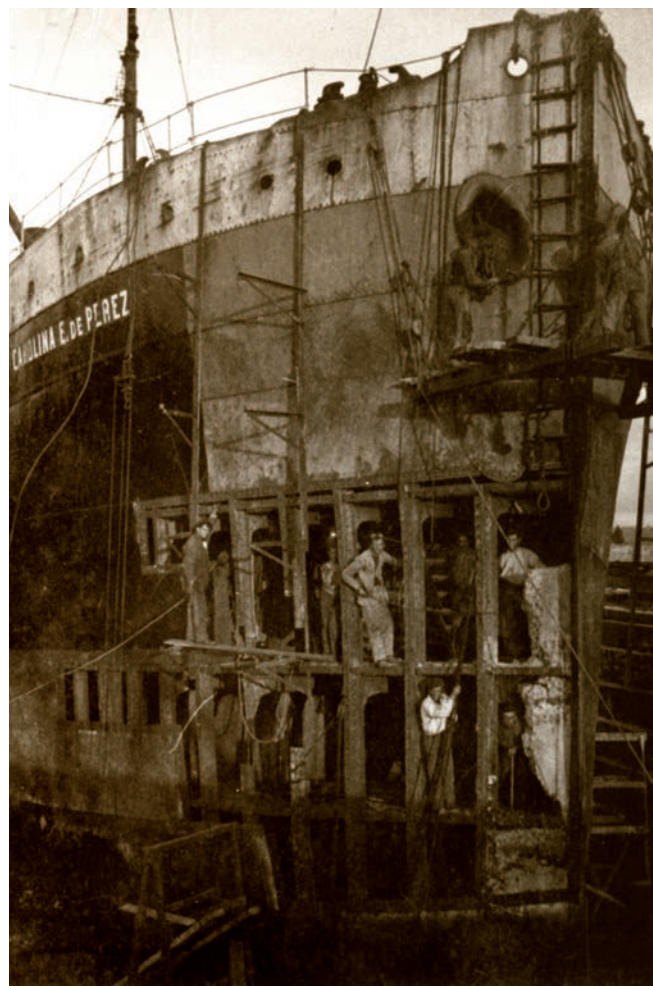
Gran reparación de una proa en los astilleros de EL Astillero
